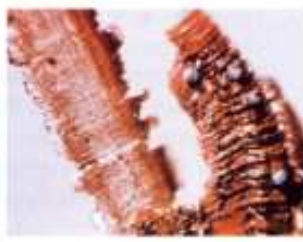
Corrosion dans le sol
